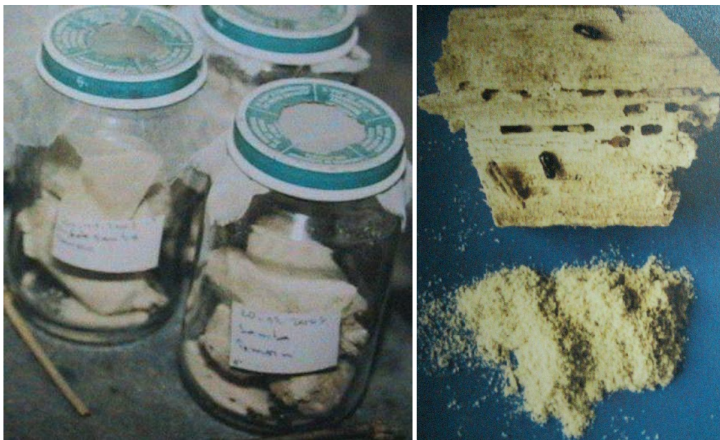
Photos 1 et 2 : Respectivement les bocaux d'essais (essence de Samba avec vermoulure) et morceau de bois présentant des perforations et vermoulure produite sur l'essence de bois de Samba suite aux attaques de X. nitidipennis (Photos essais, Doumbia, 2008).
