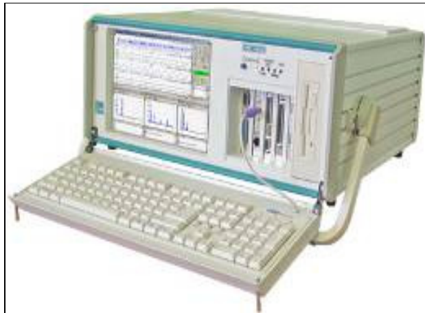
Figure 1: Complexe de mesure MIC 400D (a) et schéma d'installation pour la détermination de l'état de contrainte-déformation du sol (b).
