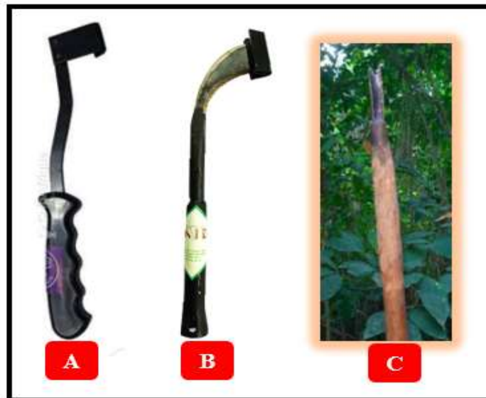
Figure 2 : Différents couteaux de saignée recensés au cours de l'étude
