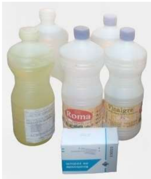
Fig.2. Dispositif de test au vinaigre d'alcool (bidon en fermeture bleu), Acide chlorhydrique (bidon en fermeture blanc) et le paquet de bicarbonate de sodium.
