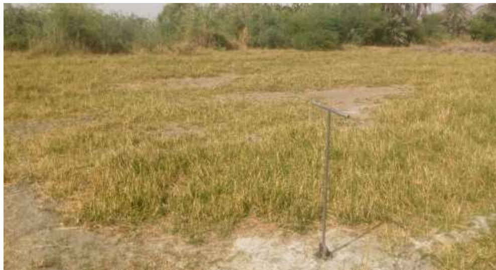
Fig.1. Tarière d'Edelman fixé dans le polder de Mandi en vue d'éventuel échantillonnage de sols dans une parcelle abandonnée
