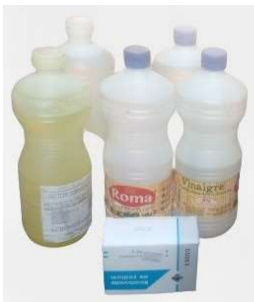
Fig.2. Dispositif de test au vinaigre d'alcool (bidon en fermeture bleu), Acide chlorhydrique (bidon en fermeture blanc) et le paquet de bicarbonate de sodium.
