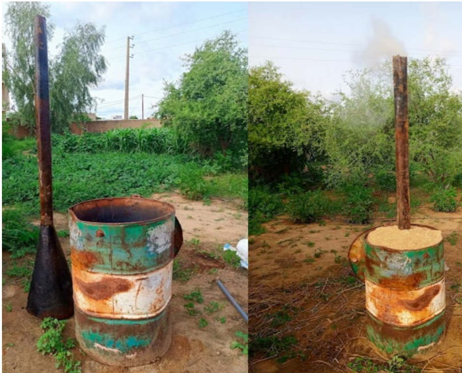
Figure 3 : Dispositif artisanal de production de biochar de balle de riz (Fall, 2025)
